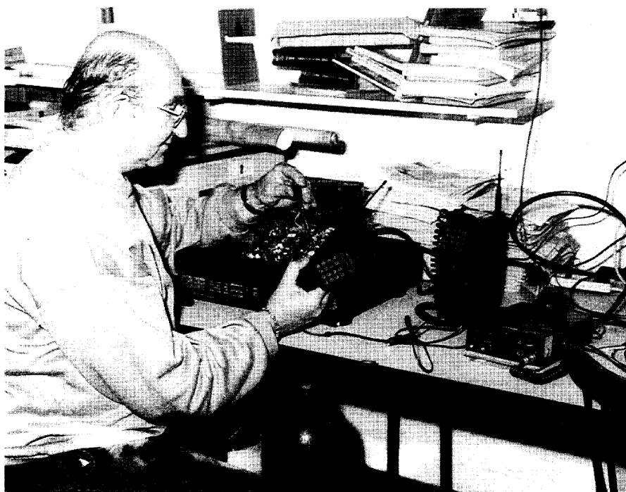
Otto Simmelink, PE1BBV, laat zien hoe de 'verbouwde' Nokia AFT2 wordt afgeregeld.
